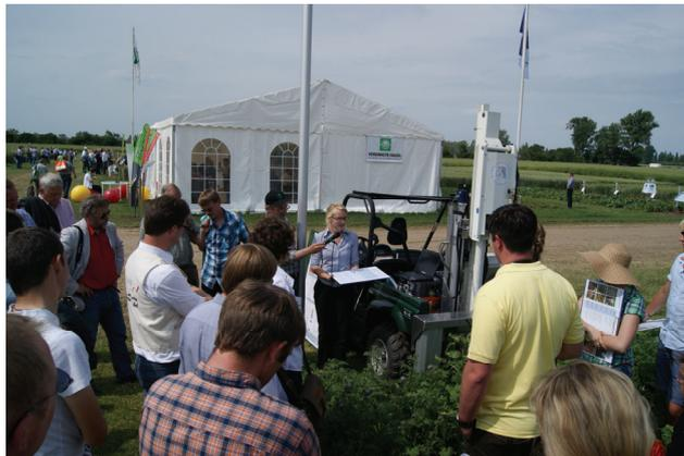
Messung auf Schwarzerde – biologische Bodenansprache wird durch elektrisches Penetrometer unterstützt
